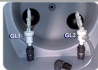
Регулировочный винт GL1 (контроль уровня наполнения, емкость)
